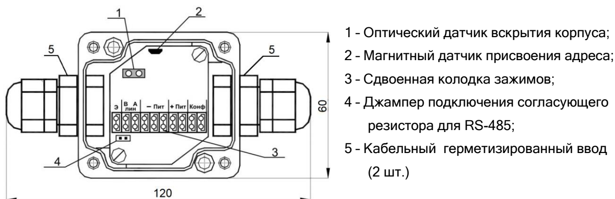
Рисунок 1 - Общий вид датчика ВД-5
